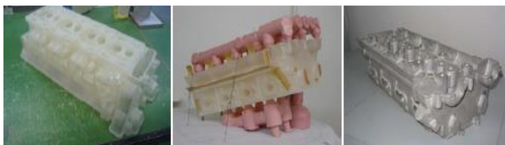
Quick-Cast модель, она же с литнековой системой и отливка головки цилиндров ДВС
