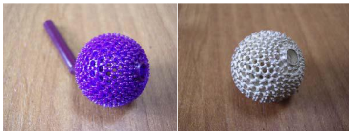
SLA-модель и отливка изделия «шарик», серебро
