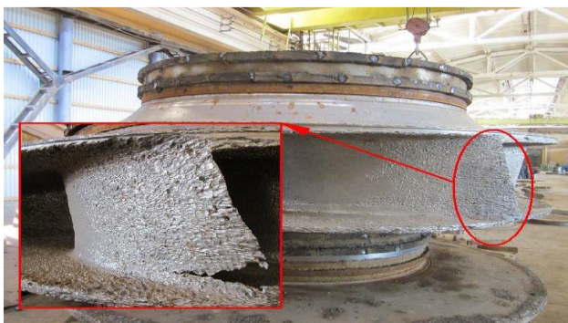
1 -расм. Насос ишчи ғилдирагининг кавитация ва гидроабразив заррачалар таъсирида ейилиши
